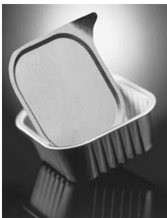
Figura B7.4.d. Tipico contenitore realizzato con alluminio accoppiato internamente a film di CPP verniciato esternamente, coperchio termosaldabile verniciato esternamente e rivestito per costruzione con PP
